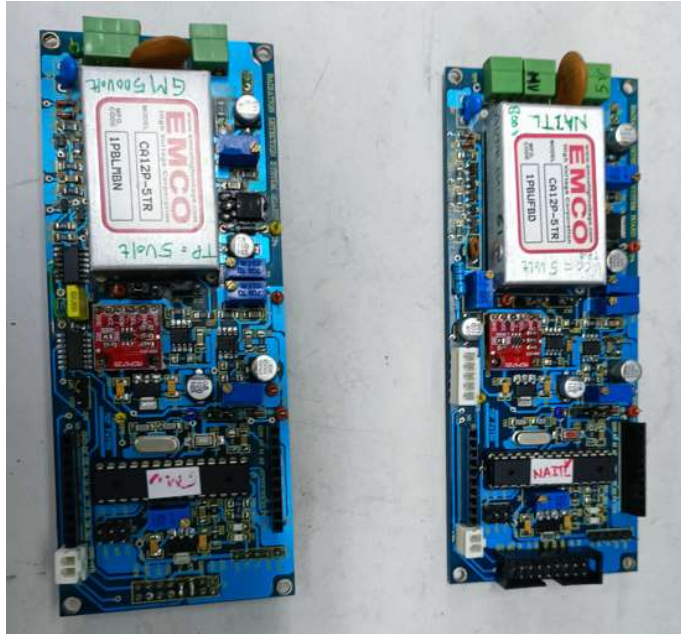
Gambar Sistem pengatur HV untuk GM dan NaI(tl)
